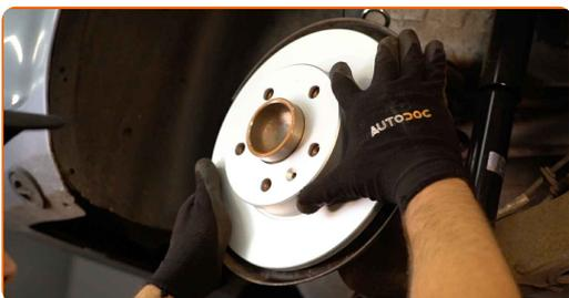
**42** Ziehen Sie die Befestigung der Bremsscheibe fest. Verwenden Sie den Torx T30. Verwenden Sie einen Drehmomentschlüssel. Ziehen Sie ihn mit 4 Nm Drehmoment fest.
