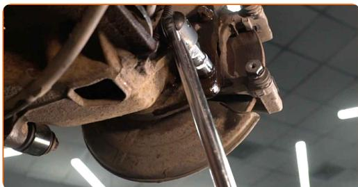
**18** Entfernen Sie die Sattelhalterung.
