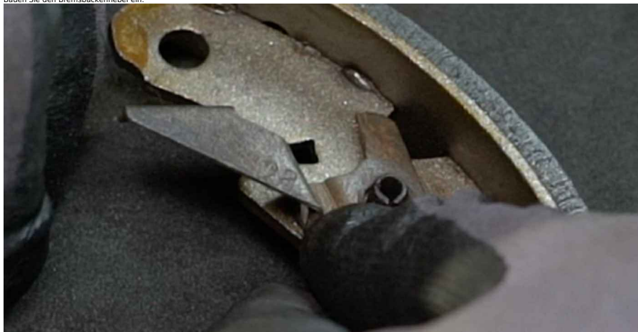
34 Bringen Sie den Sicherungsring an.
