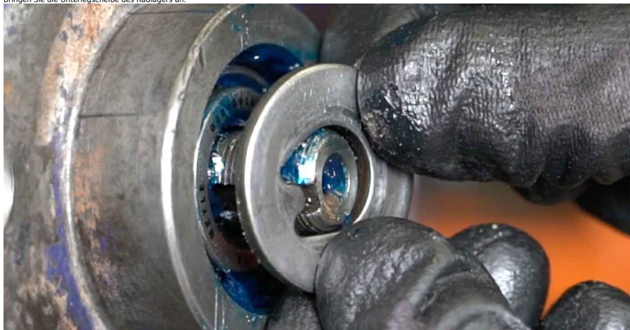
46 Schrauben Sie die Nabenmutter an. Verwenden Sie Stecknuss Nr. 24. Verwenden Sie einen Ratschenschlüssel.
