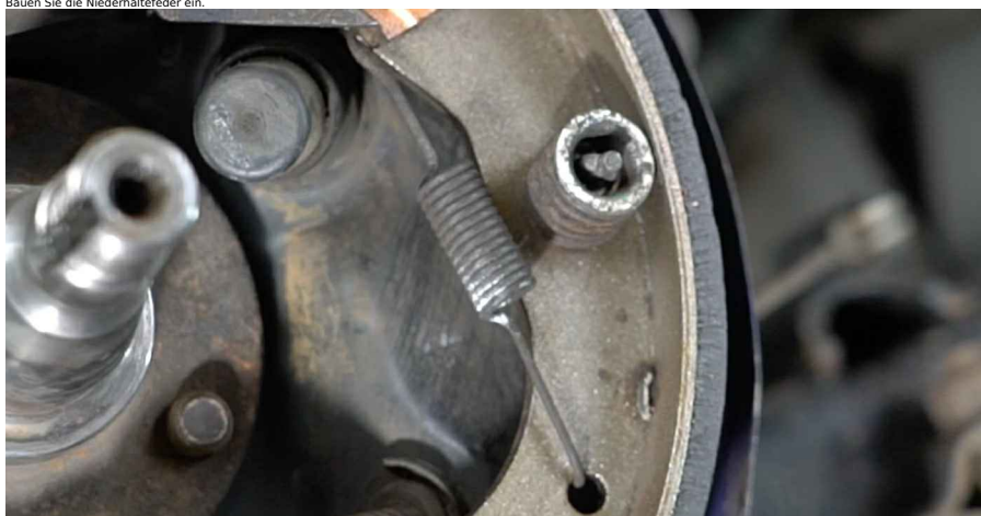
40 Bauen Sie die obere Rückholfeder ein. Verwenden Sie eine Spitzzange.
