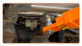
Installieren Sie einen neuen Kraftstofffilter.
