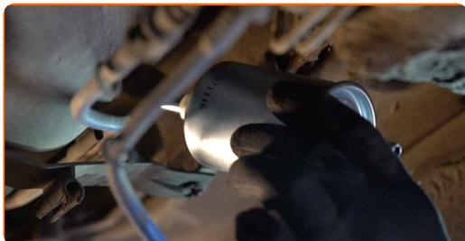
**10** Ziehen Sie die Befestigungsmittel des Treibstofffilters fest. Verwenden Sie den Torx T20.
