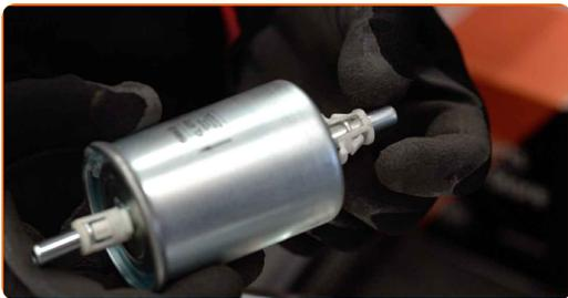
**9** Installieren Sie einen neuen Kraftstofffilter.
