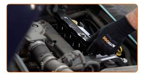
Ziehen Sie die Zündspulen Befestigung an. Verwenden Sie den Torx T30. Verwenden Sie einen Drehmomentschlüssel. Ziehen Sie ihn mit 15 Nm Drehmoment fest.
