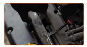
Entnehmen Sie die Zündspule aus der Vertiefung für die Zündkerze.
