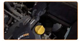
Schrauben Sie die Zündspulenklammer ab. Verwenden Sie den Torx T30. Verwenden Sie einen Ratschenschlüssel.
