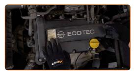
Ziehen Sie den Anschluss der Zündspule ab. Verwenden Sie einen flachen Schraubendreher.
