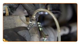
Drücken Sie mehrere Male auf das Bremspedal, um jegliche Luft aus dem System entweichen zu lassen.
