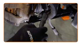
Bringen Sie den Dichtring am neuen Bremsschlauch an.
