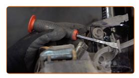
Lösen Sie den Bremsschlauch vom Federbein.
