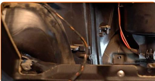
**12** Bringen Sie die Befestigungen an, die die Luftleitung und den Kabelbaum mit dem Luftfiltergehäuse verbinden.
