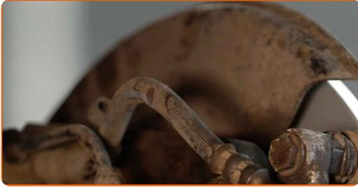
**27** Entfernen Sie den Schmutz von der Schraube zur Befestigung des Bremsschlauchs. Benutzen Sie eine Drahtbürste. Benutzen Sie einen Bremsenreiniger.
