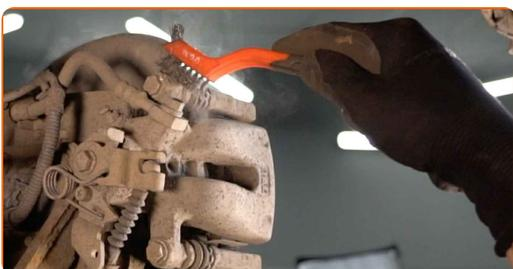
**8** Reinigen Sie den Bereich, in welchem der Bremsschlauch an den Bremssattel angeschlossen ist, sowie den Bereich der Führungsbolzen. Benutzen Sie eine Drahtbürste. Benutzen Sie einen Bremsenreiniger.
