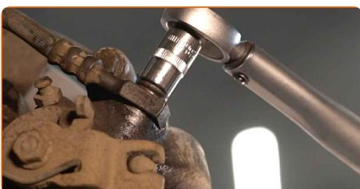
**26** Entfernen Sie die Klammer des Bremsschlauchs.
