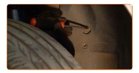
6 Entfernen Sie die Radkastenabdeckung.
