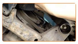
8 Entfernen Sie den Keilrippenriemen.
