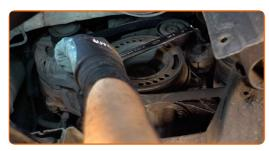
Setzen Sie den Keilrippenriemen auf die Spannrolle auf.
