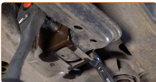
**12** Lösen Sie die Befestigung, die das Kugelgelenk des Querlenkers mit dem Achsschenkel verbindet. Verwenden Sie einen flachen Metallmeißel. Benutzen Sie einen Hammer.
