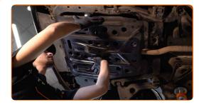
Ziehen Sie die Befestigungen der unteren Ölwannen-Abdeckung fest. Verwenden Sie Stecknuss Nr. 12. Verwenden Sie einen Ratschenschlüssel.
