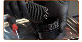
Den Dichtungsring des Ölfilterdeckels entfernen. Verwenden Sie einen flachen Schraubendreher.
