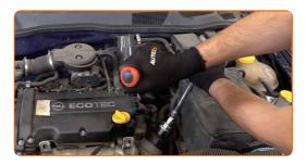
Entfernen Sie die Öleinfüllschraube.
