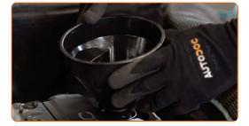
Füllen Sie neues Öl in der vom Fahrzeughersteller empfohlenen Menge in den Motor ein.
