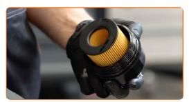
Schmieren Sie die Gummidichtung des neuen Filters mit einer kleinen Menge frischen Öls.
