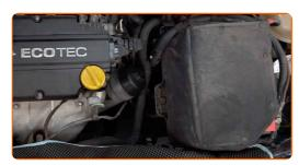
Schrauben Sie den Filtergehäusedeckel zusammen mit dem alten Filterelement ab. Verwenden Sie Stecknuss Nr. 32. Verwenden Sie einen Ratschenschlüssel.
