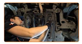
Nehmen Sie die Ölwannen-Abdeckung ab. Verwenden Sie Stecknuss Nr. 12. Verwenden Sie einen Ratschenschlüssel.
