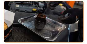
Bedecken Sie das Ölfiltergehäuse mit einem Mikrofasertuch, um zu verhindern, dass Schmutz und Fremdkörper in das System gelangen.
