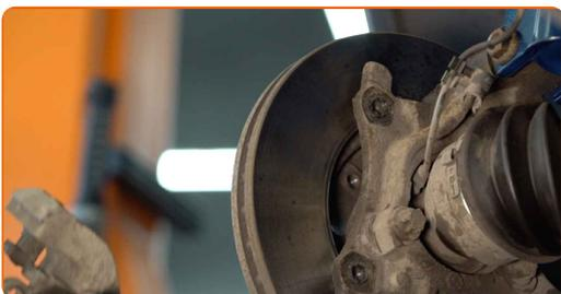
**16** Reinigen Sie die Befestigungselemente der Bremsscheibe. Benutzen Sie eine Drahtbürste. Benutzen Sie WD-40-Spray.
