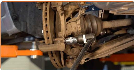
**15** Entfernen Sie die Sattelhalterung.
