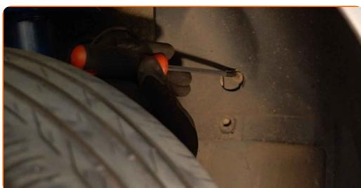
**6** Entfernen Sie die Radkastenabdeckung.
