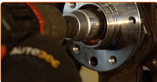
**42** Behandeln Sie die Radnabe an der Kontaktstelle mit der Bremsscheibe. Benutzen Sie ein Kupferschmiermittel.
