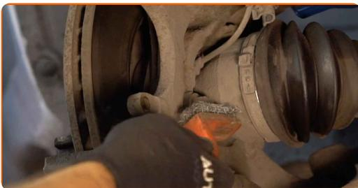
**14** Lösen Sie die Befestigung der Sattelhalterung. Verwenden Sie Stecknuss Nr. 18. Verwenden Sie ein Windeisen.
