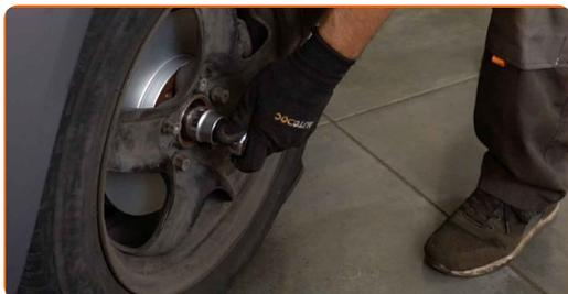
**58** Ziehen Sie die Radschrauben unter Verwendung eines Kreuzmusters an. Verwenden Sie einen Drehmomentschlüssel. Ziehen Sie ihn mit 110 Nm Drehmoment fest.
