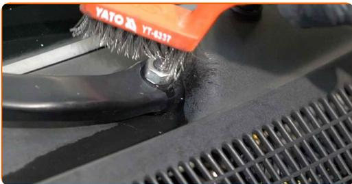
**6** Lösen Sie die Befestigungen der Frontscheibenwischerarme. Verwenden Sie Stecknuss Nr. 13. Verwenden Sie einen Ratschenschlüssel.
