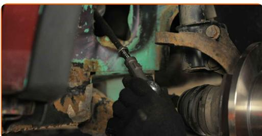
**Austausch: Spurstangenkopf – OPEL COMBO Kasten/Kombi. Fachleute empfehlen:**
