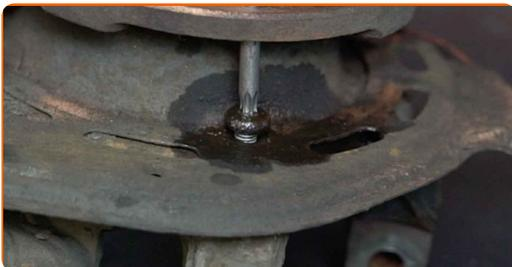
**33** Entfernen Sie das Bremsenabdeckblech.
