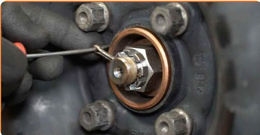
**3** Drehen Sie das Befestigungselement der Antriebswelle auf. Verwenden Sie Stecknuss Nr. 30. Verwenden Sie ein Windeisen.
