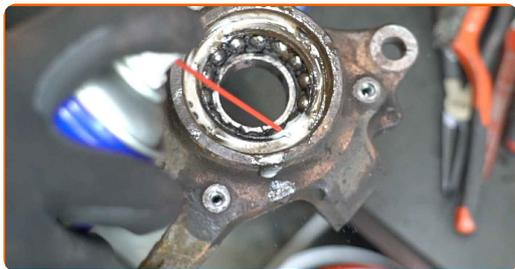
**38** Drücken Sie das Radnabenlager heraus. Verwenden Sie einen Druckstücksatz mit Ein-/Auspresswerkzeug.
