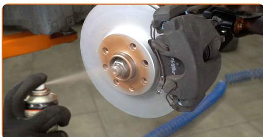
**73** Die Bremsscheibenoberfläche reinigen. Benutzen Sie einen Bremsenreiniger.
