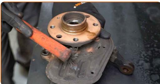
**32** Lösen Sie die Befestigungen des Bremsenabdeckblechs. Verwenden Sie den Torx T30.
