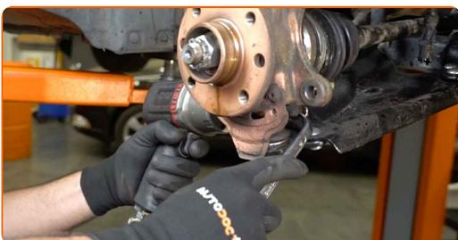
**25** Entfernen Sie die Befestigungsschraube.
