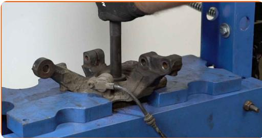
**35** Reinigen Sie die Befestigungen des Radnabenlagers. Benutzen Sie eine Drahtbürste. Benutzen Sie WD-40-Spray.
