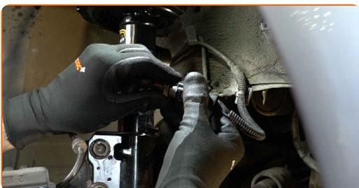
**70** Verbinden Sie das ABS mit der Sensorverdrahtung.
