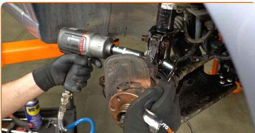
**23** Entfernen Sie die Befestigungsschraube.
