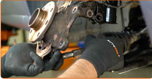
**29** Entfernen Sie die Befestigungsschraube.
