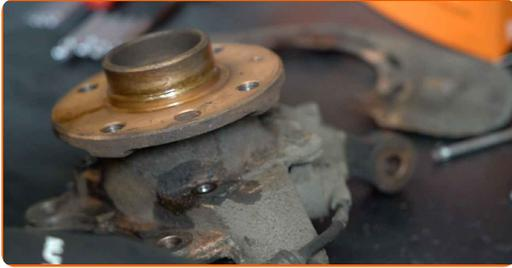
**34** Entfernen Sie die Radnabe vom Achsschenkel. Verwenden Sie einen Druckstücksatz mit Ein-/Auspresswerkzeug.
