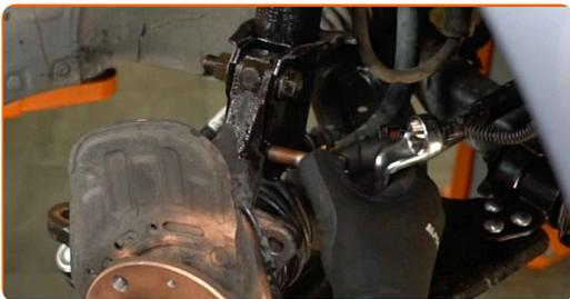
**24** Schrauben Sie die Befestigung ab, die das Kugelgelenk mit dem Achsschenkel verbindet. Verwenden Sie Ring-Gabelschlüssel Nr. 16. Verwenden Sie Stecknuss Nr. 16. Verwenden Sie einen Ratschenschlüssel.
