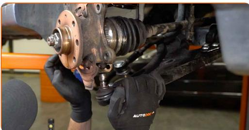
**27** Lösen Sie das Befestigungselement, welches die Antriebswelle mit der Radnabe verbindet.
