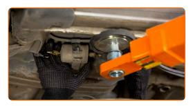
Installieren Sie einen neuen Kraftstofffilter.
