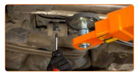
Drücken Sie die Clips zusammen und lösen Sie die Kraftstoffzufuhrleitungen vom Kraftstofffiltergehäuse. Verwenden Sie Kraftstoffleitungszangen.
