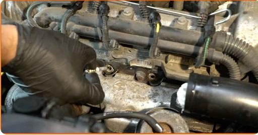
**13** Schrauben Sie die Glühkerzen fest. Verwenden Sie die Zündkerzennuss # 8. Verwenden Sie einen Drehmomentschlüssel. Ziehen Sie ihn mit 10 Nm Drehmoment fest.
