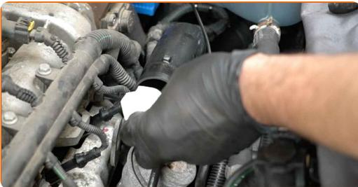
**8** Lösen Sie die Steckverbinder der Glühkerzenverkabelung.
