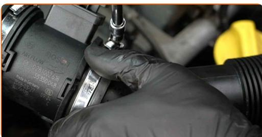
**18** Schrauben Sie das Befestigungselement des Luftansaugrohrs ein. Verwenden Sie den Torx T25.
