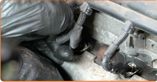
**9** Schrauben Sie die Glühkerzen aus. Verwenden Sie die Zündkerzennuss # 8. Verwenden Sie einen Ratschenschlüssel.
