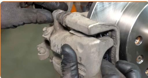
**19** Schrauben Sie die Befestigung des Bremsschlauchs fest. Verwenden Sie Stecknuss Nr. E11. Verwenden Sie einen Drehmomentschlüssel. Ziehen Sie ihn mit 15 Nm Drehmoment fest.
