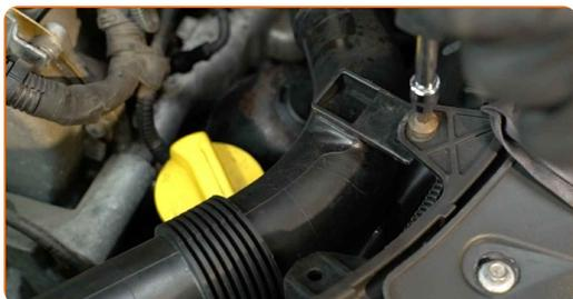
**19** Installieren Sie die Motorabdeckung und sichern Sie diese.
