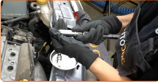
**20** Tragen Sie eine dünne Schicht eines speziellen Hochtemperatur-Anti-Seize-Schmiermittels auf das Gewinde der neuen Zündkerzen auf.
