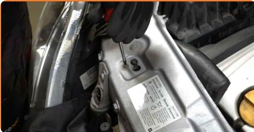
**4** Entferne die Komponenten des Lüftungskanals.
