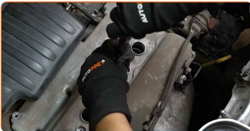
**22** Schrauben Sie die neuen Zündkerzen an und ziehen Sie diese fest. Verwenden Sie die Zündkerzennuss # 16. Verwenden Sie einen Drehmomentschlüssel. Ziehen Sie ihn mit 24 Nm Drehmoment fest.
