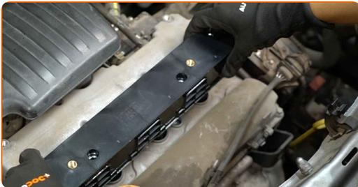
**24** Schrauben Sie die Schrauben der Zündspule fest. Verwenden Sie den Torx T30. Verwenden Sie einen Drehmomentschlüssel. Ziehen Sie ihn mit 7 Nm Drehmoment fest.
