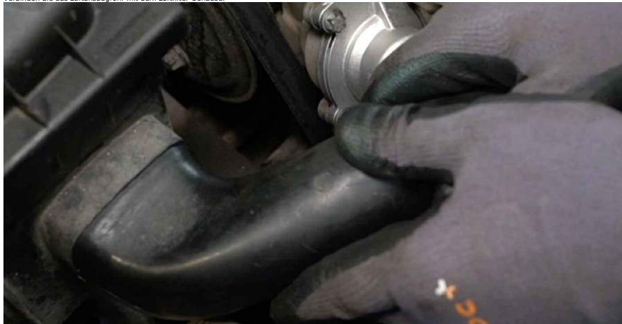
32 Bringen Sie die Klammer am Luftfilteransaugschlauch an.
