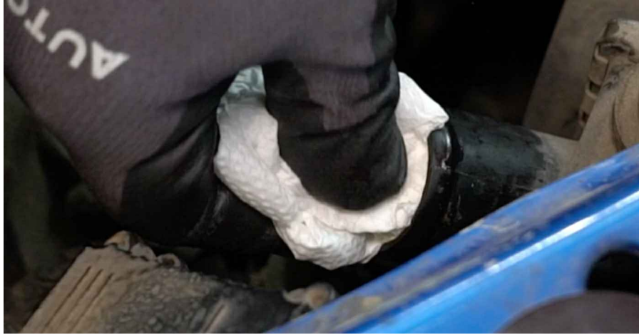
19 Reinigen Sie das Thermostatgehäuse. Benutzen Sie eine Drahtbürste. Verwenden Sie Allzweckreinigungsspray.
