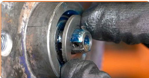
**26** Schrauben Sie die Nabenmutter an. Verwenden Sie Stecknuss Nr. 24. Verwenden Sie einen Ratschenschlüssel.
