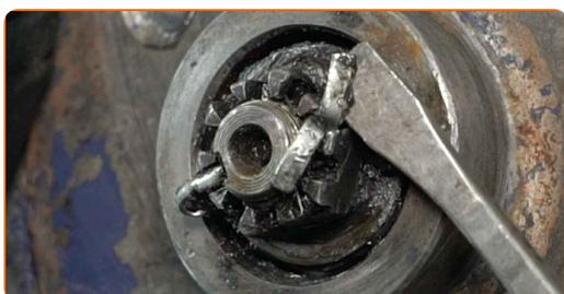
**8** Schrauben Sie die Nabenmutter ab. Verwenden Sie Stecknuss Nr. 24. Verwenden Sie einen Ratschenschlüssel.
