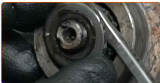
**10** Entfernen Sie das Radnabenlager. Benutzen Sie ein Brecheisen.
