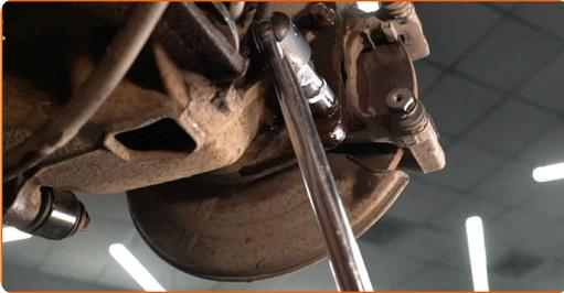
**18** Entfernen Sie die Sattelhalterung.
