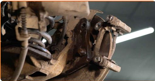
**19** Reinigen Sie die Befestigungselemente der Bremsscheibe. Benutzen Sie eine Drahtbürste. Benutzen Sie WD-40-Spray.
