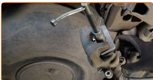
**31** Installieren Sie den Bremssattel und fixieren Sie diesen.
