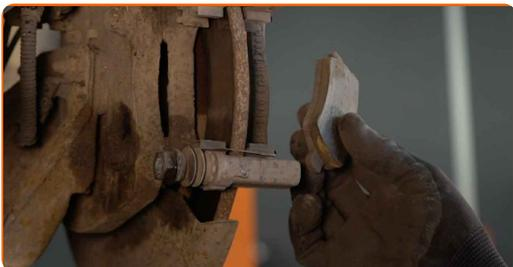
**16** Die Befestigungselemente der Bremssattelhalterung reinigen. Benutzen Sie eine Drahtbürste. Benutzen Sie einen Bremsenreiniger.
