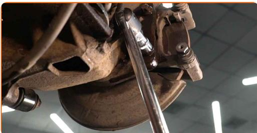
**18** Entfernen Sie die Sattelhalterung.
