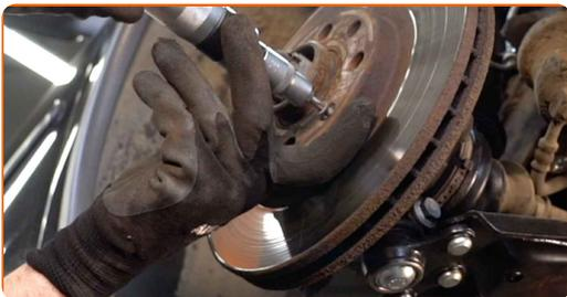
**17** Entfernen Sie die Bremsscheibe.
