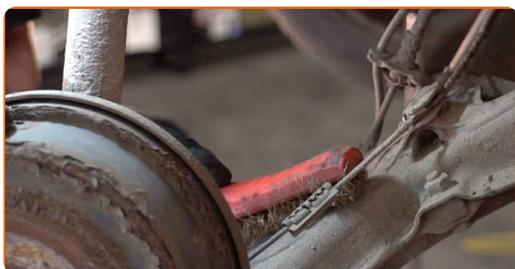
**19** Bauen Sie die Spiralfeder zusammen mit den Gummilager in deren Aufnahmen ein.
