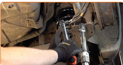
**25** Die Montage unter dem Hinterachsträger entfernen.
