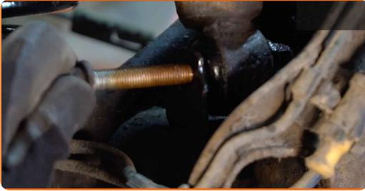
**31** Schrauben Sie das untere Befestigungselement des Stoßdämpfers ein. Verwenden Sie Stecknuss Nr. E14.
