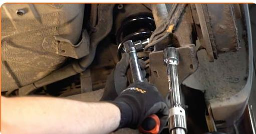
**34** Die Montage unter dem Hinterachsträger entfernen.
