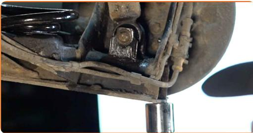
**33** Ziehen Sie den unteren Befestiger des Stoßdämpfers an. Verwenden Sie Stecknuss Nr. E14. Verwenden Sie einen Drehmomentschlüssel. Ziehen Sie ihn mit 110 Nm Drehmoment fest.
