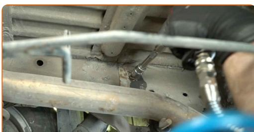
**6** Entfernen Sie die Befestigungsbolzen.
