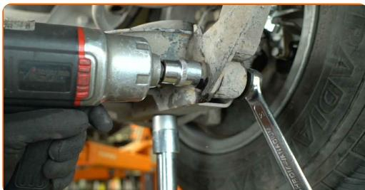
**5** Schrauben Sie den oberen Befestigungsbolzen des Stoßdämpfers ab. Verwenden Sie einen Ringmaulschlüssel mit einem Durchmesser von 21 mm. Verwenden Sie eine Stecknuss mit einem Durchmesser von 21 mm. Verwenden Sie einen Ratschenschlüssel.
