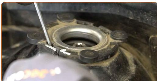
**20** Entfernen Sie die Befestigungsschrauben.
