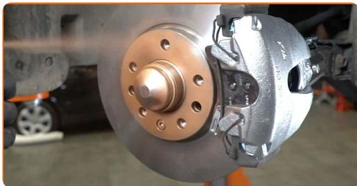
**56** Die Bremsscheibenoberfläche reinigen. Benutzen Sie einen Bremsenreiniger.
