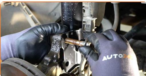
**44** Bringen Sie die Befestigungsklammer des oberen Domlagers an. Verwenden Sie eine Wasserpumpenzange.
