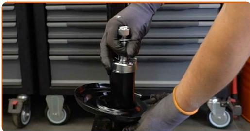
**33** Installieren Sie die Feder am Stoßdämpfer.
