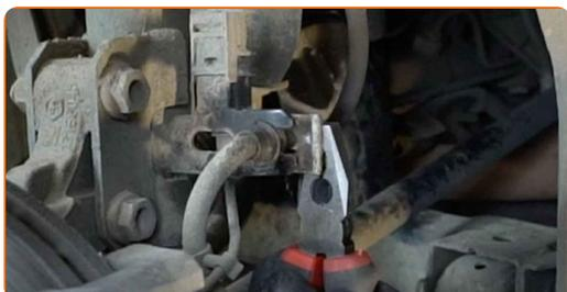
**13** Lösen Sie den Bremsschlauch vom Federbein.
