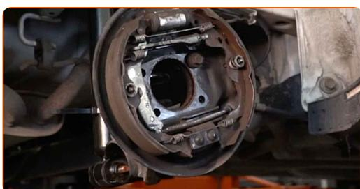
**15** Reinigen Sie den Einbauort für die Nabenlagerung. Benutzen Sie eine Drahtbürste.
