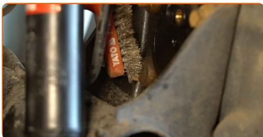
**13** Schrauben Sie die Nabenlagerhalterung ab. Verwenden Sie Stecknuss Nr. 12. Verwenden Sie einen Ratschenschlüssel. Verwenden Sie ein Windeisen.
