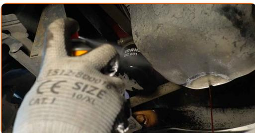
**11** Schrauben Sie den Ölfilter ab. Verwenden Sie Steckschlüssel 67-14F. Verwenden Sie einen Ratschenschlüssel.
