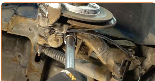
**11** Entfernen Sie die Befestigungsschraube.
