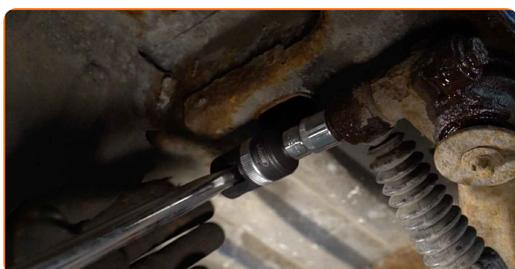
**8** Entfernen Sie die Befestigungsschraube.
