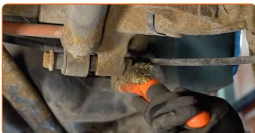
**7** Schrauben Sie das obere Befestigungselement des Stoßdämpfers ab. Verwenden Sie Ring-Gabelschlüssel Nr. 19. Verwenden Sie Stecknuss Nr. 19. Verwenden Sie einen Ratschenschlüssel.
