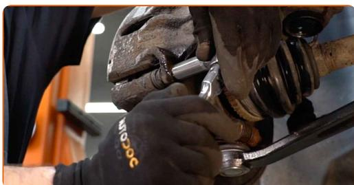
**10** Entfernen Sie den Bremssattel.
