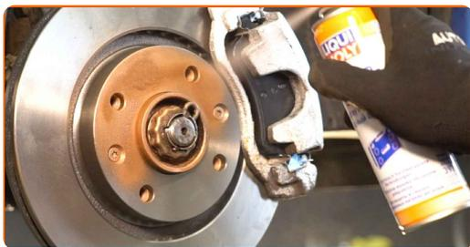
**70** Die Bremsscheibenoberfläche reinigen. Benutzen Sie einen Bremsenreiniger.
