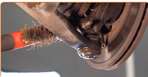
**19** Schrauben Sie die Kugelgelenkbefestigung vom Achsschenkel ab. Verwenden Sie Ring-Gabelschlüssel Nr. 17. Verwenden Sie Stecknuss Nr. 17.
