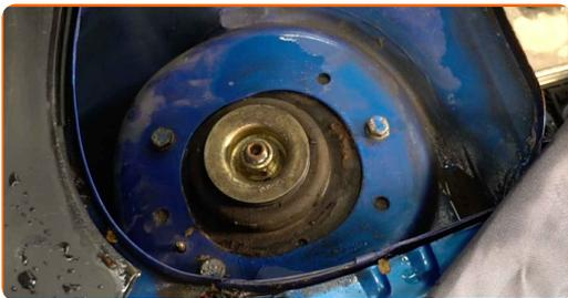
**5** Lösen Sie die obere Befestigung des Domlagers. Verwenden Sie Stecknuss Nr. 13. Verwenden Sie einen Ratschenschlüssel.
