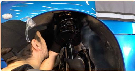
**50** Schrauben Sie die obere Befestigung des Domlagers an. Verwenden Sie Stecknuss Nr. 13. Verwenden Sie einen Ratschenschlüssel. Schrauben Sie diese nicht fest.
