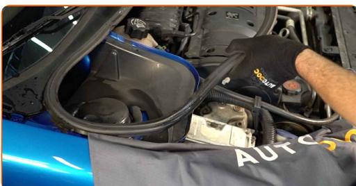
**4** Entfernen Sie die Kappe des Federbeinstützlagers.
