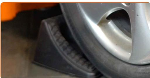
**7** Lösen Sie die Radhalterungsschrauben. Verwenden Sie eine Schlagnuss für Felgen # 19.
