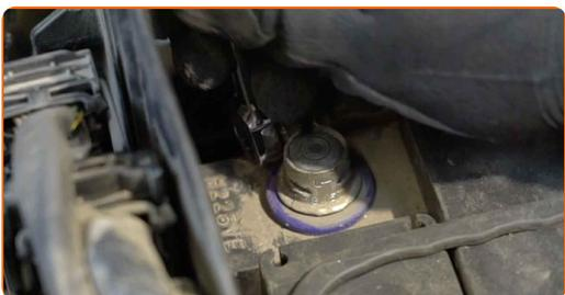
**7** Entfernen Sie die Batterieklemmen.
