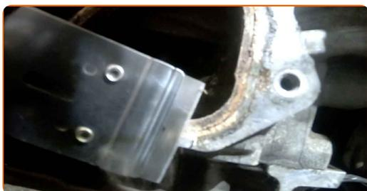
**38** Installieren Sie das neue Thermostatgehäuse.
