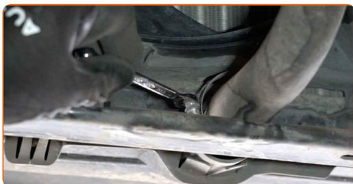
**18** Lösen Sie die untere Kühlmittleitung.
