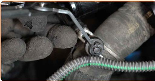
**48** Bringen Sie den Kühlmittelschlauch an.
