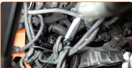
**45** Bringen Sie den Kühlmittelschlauch an.
