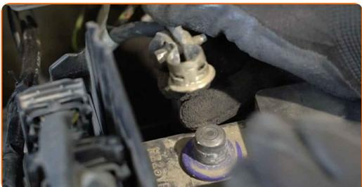
**8** Drücken Sie auf die Batteriehalterungen, um sie zu lösen.
