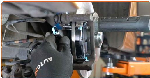
**33** Installieren Sie den Bremssattel und fixieren Sie diesen. Verwenden Sie Ring-Gabelschlüssel Nr. 19. Verwenden Sie Stecknuss Nr. 13. Verwenden Sie einen Drehmomentschlüssel. Ziehen Sie ihn mit 30 Nm Drehmoment fest.
