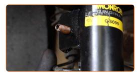
Ziehen Sie das Befestigungselement an, das die Druckstange mit dem Federbein verbindet. Verwenden Sie Stecknuss Nr. 17. Verwenden Sie einen Drehmomentschlüssel. Ziehen Sie ihn mit 43 Nm Drehmoment fest.
