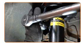
Ziehen Sie das Befestigungselement an, das die Druckstange mit dem Stabilisator verbindet. Verwenden Sie Stecknuss Nr. 17. Verwenden Sie einen Drehmomentschlüssel. Ziehen Sie ihn mit 43 Nm Drehmoment fest.
