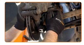
Verbinden Sie den Unterarm mit dem Achsschenkel.
