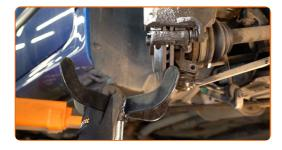
Ziehen Sie den unteren Arm vom Achsschenkel ab. Benutzen Sie ein Brecheisen.
