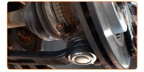
Schrauben Sie die Befestigungen des Kugelgelenks ein. Verwenden Sie Stecknuss Nr. 17. Verwenden Sie Ring-Gabelschlüssel Nr. 17.
