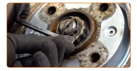
Drehen Sie das Befestigungselement der Antriebswelle auf. Verwenden Sie Stecknuss Nr. 32. Verwenden Sie ein Windeisen. Benutzen Sie ein Brecheisen.
