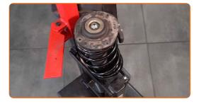
Entfernen Sie das zusammengebaute Federbein.
