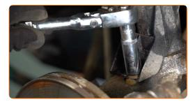
Ziehen Sie die Antriebswelle aus dem Achsschenkel und verbinden Sie diese mit dem Körper.
