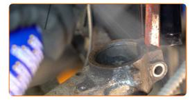
Befestigen Sie das Dämpferbein auf dem Achsschenkel.
