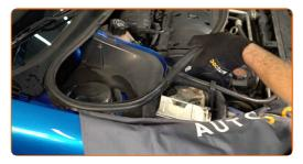
Entfernen Sie die Kappe des Federbeinstützlagers.
