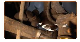
Schrauben Sie den Bremsschlauch-Befestigungswinkel aus dem Federbein heraus. Verwenden Sie Stecknuss Nr. 13. Verwenden Sie einen Ratschenschlüssel.
