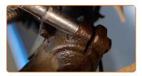
Entfernen Sie die Befestigungsschraube.
