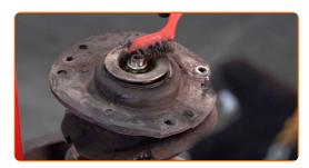
Entfernen Sie die Stangenmutter des Federkolben. Verwenden Sie Stecknuss Nr. 21. Verwenden Sie Inbusschlüssel Nr. H7. Verwenden Sie einen Ratschenschlüssel.
