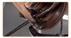
Entfernen Sie den Träger unter dem Achsschenkel.
