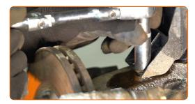
Entfernen Sie den Träger unter dem Achsschenkel.
