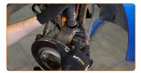
Lösen Sie die obere Befestigung des Domlagers. Verwenden Sie Stecknuss Nr. 13. Verwenden Sie einen Ratschenschlüssel.
