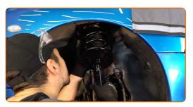
Schrauben Sie die obere Befestigung des Domlagers an. Verwenden Sie Stecknuss Nr. 13. Verwenden Sie einen Ratschenschlüssel. Schrauben Sie diese nicht fest.
