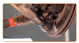
Schrauben Sie die Kugelgelenkbefestigung vom Achsschenkel ab. Verwenden Sie Ring-Gabelschlüssel Nr. 17. Verwenden Sie Stecknuss Nr. 17.
