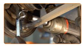
20 Entfernen Sie die Befestigungsschraube.
