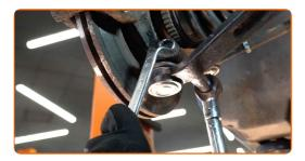
Ziehen Sie die unteren Befestigungen an, die das Federbein mit dem Achsschenkel verbinden. Verwenden Sie Stecknuss Nr. 18. Verwenden Sie einen Drehmomentschlüssel. Ziehen Sie ihn mit 55 Nm Drehmoment fest.
