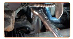
Montieren Sie den Querlenker. Verwenden Sie Stecknuss Nr. 16.
