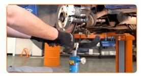
Ziehen Sie den Achsschenkel vom Dämpferbein ab. Benutzen Sie einen Hammer.
