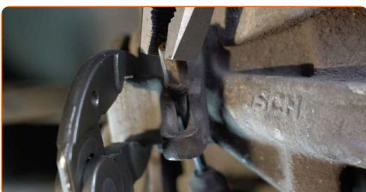
**9** Die Bremssattelbefestigungen reinigen. Benutzen Sie eine Drahtbürste. Verwenden Sie Allzweckreinigungsspray.
