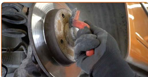
**18** Entfernen Sie die Radnabenkappe. Benutzen Sie ein Brecheisen. Verwenden Sie einen Gummi-Hammer.
