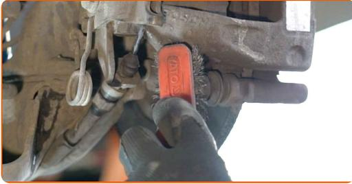
**10** Schrauben Sie die Befestigung des Bremssattels ab. Verwenden Sie Ring-Gabelschlüssel Nr. 19. Verwenden Sie Stecknuss Nr. 13. Verwenden Sie einen Ratschenschlüssel.
