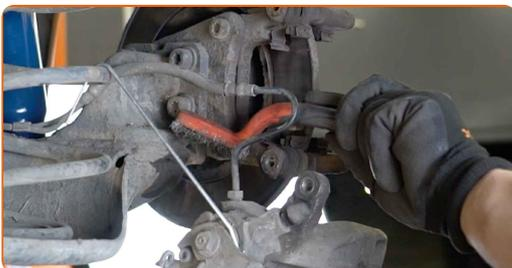
**15** Lösen Sie die Befestigung der Sattelhalterung. Verwenden Sie den Torx T55. Verwenden Sie ein Windeisen.
