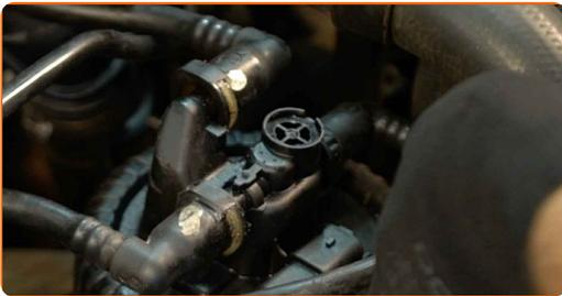
**18** Verbinden Sie die Kraftstoffversorgungsleitungen zum Kraftstofffilter.
