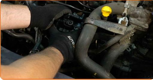
**17** Bringen Sie den Anschluss des Kraftstoffdrucksensors an.
