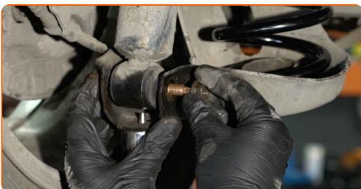
**21** Ziehen Sie den unteren Befestiger des Stoßdämpfers an. Verwenden Sie Ring-Gabelschlüssel Nr. 13. Verwenden Sie Stecknuss Nr. 15. Verwenden Sie einen Drehmomentschlüssel. Ziehen Sie ihn mit 57 Nm Drehmoment fest.
