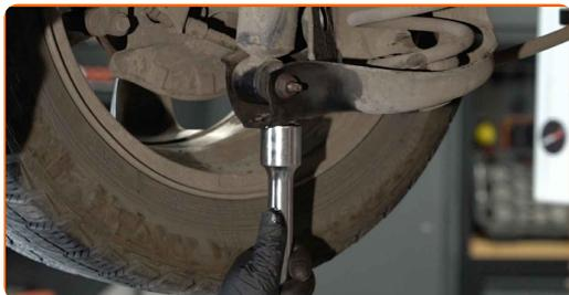
**12** Reinigen Sie die Stoßdämpferbefestigungen. Benutzen Sie eine Drahtbürste. Benutzen Sie WD-40-Spray.
