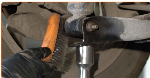
**13** Schrauben Sie den unteren Befestiger des Stoßdämpfers ab. Verwenden Sie Ring-Gabelschlüssel Nr. 13. Verwenden Sie Stecknuss Nr. 15. Verwenden Sie einen Ratschenschlüssel.
