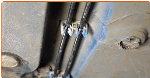
**13** Den Flüssigkeitsbehälter unter dem Kraftstofffilter entfernen.
