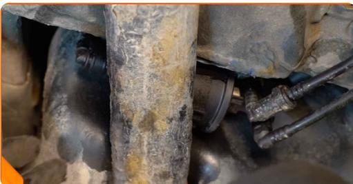
**12** Montieren Sie die Kraftstoffleitungen in der Karosserie.
