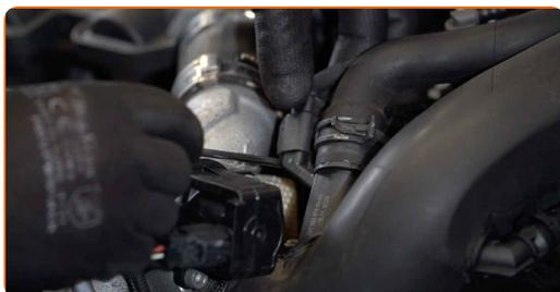
**3.2** Drücken Sie die Halteklammer mit einer Kombizange und lösen Sie den Schlauch des Vakuumventils.
