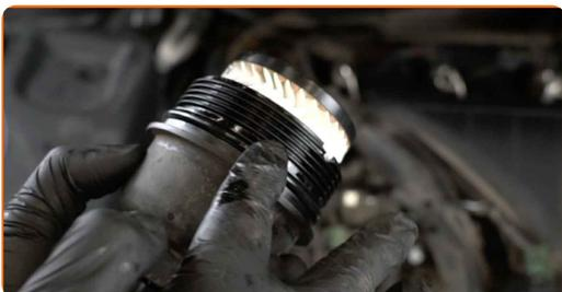
**19** Befestigen Sie die Abdeckung des Ölfiltergehäuses. Verwenden Sie Stecknuss Nr. 27. Verwenden Sie einen Drehmomentschlüssel. Ziehen Sie ihn mit 25 Nm Drehmoment fest.
