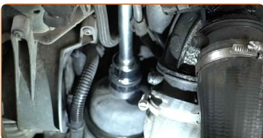
**12** Bereiten Sie einen Behälter für den alten Ölfilter vor. Legen Sie den alten Ölfilter in den Behälter.
