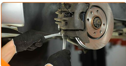
**41** Bringen Sie das Kabel des Bremsbelagverschleißsensors an.
