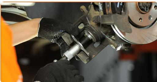
**38** Installieren Sie den Bremssattel und fixieren Sie diesen.
