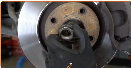
**21** Trennen Sie die Antriebswelle vom Achsschenkel. Verwenden Sie einen Splintentreiber. Benutzen Sie einen Hammer.
