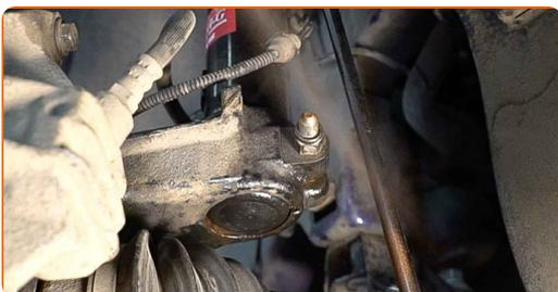
**67** Behandeln Sie die Oberfläche, an der die Bremsscheibe die Felge berührt. Verwenden Sie Hochtemperatur-Keramikfett.
