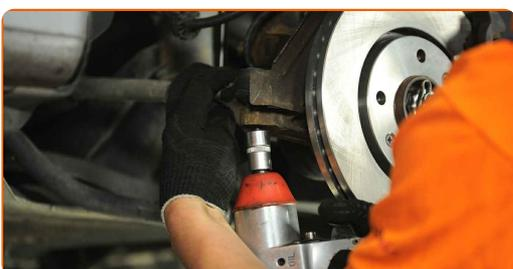
**66** Behandeln Sie die Federbein-Befestigungen. Behandeln Sie das Befestigungselement, das den Spurstangenkopf mit dem Achsschenkel verbindet. Behandeln Sie alle Gelenke der Koppelstange. Behandeln Sie die Befestigung des Kugelgelenks. Benutzen Sie ein Kupferschmiermittel.
