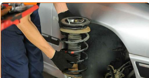
**33** Stellen Sie das Dämpferbein auf das Federspannwerkzeug.
