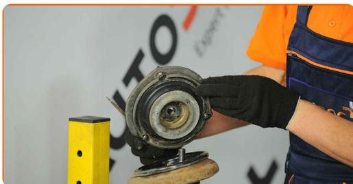
**38** Setzen Sie das neue obere Federbeinlager ein.
