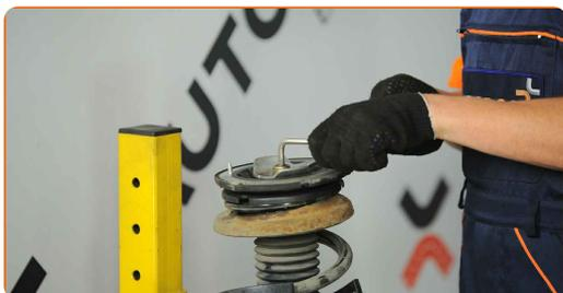
**37** Entfernen Sie das obere Domlager. Benutzen Sie ein Brecheisen.
