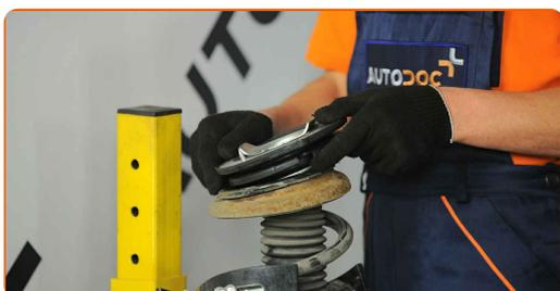
**39** Ziehen Sie die Federbeinkolbenstangenmutter an. Verwenden Sie Ring-Gabelschlüssel Nr. 21. Verwenden Sie Inbusschlüssel Nr. H6. Verwenden Sie einen Drehmomentschlüssel. Ziehen Sie ihn mit 65 Nm Drehmoment fest.
