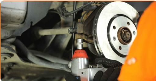
**17** Ziehen Sie die Spurstangenkopf Sicherungsmutter an. Verwenden Sie Ring-Gabelschlüssel Nr. 24. Verwenden Sie einen Drehmomentschlüssel. Ziehen Sie ihn mit 60 Nm Drehmoment fest.
