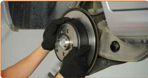
**28** Ziehen Sie die Bremsscheibenbefestigungen an. Verwenden Sie den Torx T30. Verwenden Sie einen Drehmomentschlüssel. Ziehen Sie ihn mit 10 Nm Drehmoment fest.
