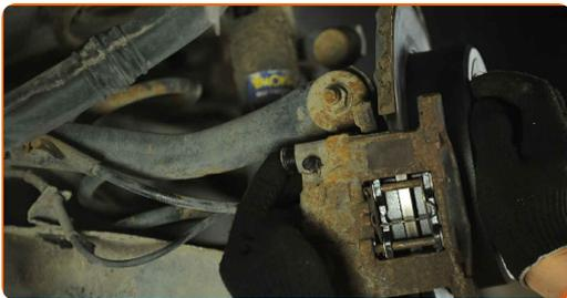
**33** Behandeln Sie die Oberfläche, an der die Bremsscheibe die Felge berührt. Verwenden Sie Hochtemperatur-Keramikfett.
