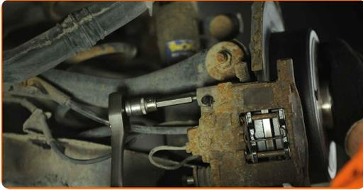
**31.2** Verwenden Sie Stecknuss Nr. 16. Verwenden Sie einen Drehmomentschlüssel. Halten Sie das empfohlene Anzugsdrehmoment ein.
