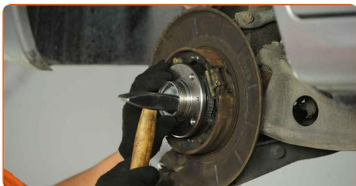
**26** Behandeln Sie die Radnabe an der Kontaktstelle mit der Bremsscheibe. Benutzen Sie ein Kupferschmiermittel.
