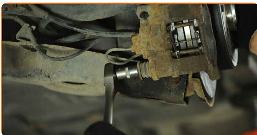
**32** Installieren Sie die Staubschutzkappen der Bremssattel-Führungsstifte.
