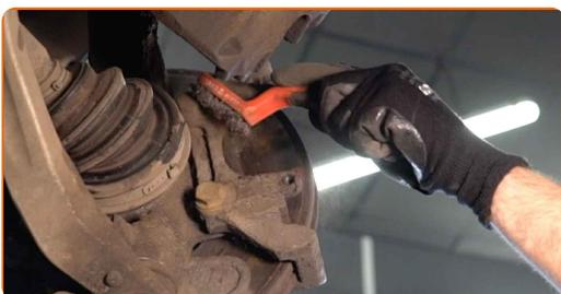
**12** Lösen Sie die Befestigung der Sattelhalterung. Verwenden Sie den Torx T55. Verwenden Sie einen Ratschenschlüssel.
