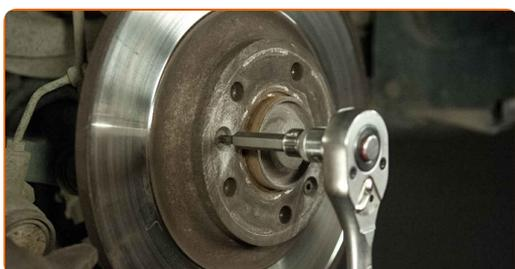
**29** Säubern Sie die Halterung des Bremssattels. Benutzen Sie eine Drahtbürste. Benutzen Sie einen Bremsenreiniger.
