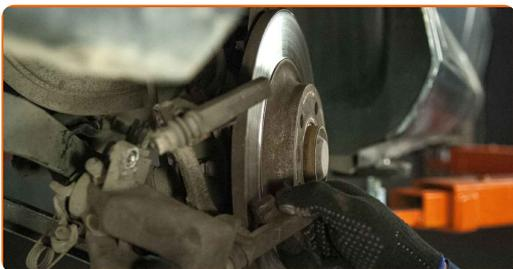
**31** Befestigen Sie die Bremssattelhalterung. Verwenden Sie den Torx T55. Verwenden Sie einen Drehmomentschlüssel. Ziehen Sie ihn mit 108 Nm Drehmoment fest.
