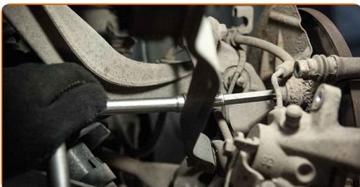
**13** Entfernen Sie die Sattelhalterung.
